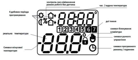
Термостат призначений для підтримки постійної температури від мінус 20 до плюс 40 С. Температура контролюється в місці розташування вносного датчика.
