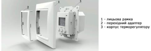
Для зменшення механічного навантаження на клемні терморегулятора, рекомендується використовувати м'який дріт типу ПБС. Клемні терморегулятора розташовані на певній відстані не більше 2,5 мм кв. Дроти затягуються за допомогою викрутки з шириною леза не більше 3 мм, в іншому випадку може відбутися механічне пошкодження клемної колодки в результаті чого гарантійні зобов'язання виробника можуть бути припинені.
