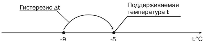
При этом охлаждающий элемент, управляемый терморегулятором, будет охлаждать морозильную камеру до -9 °С и отключаться. После повышения в ней температуры на 4°С, т.е. до -5 °С, терморегулятор снова включит охлаждающий элемент, начнется охлаждение и цикл повторится.
