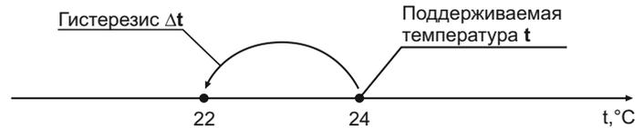
При этом нагреватель, управляемый терморегулятором, будет нагревать помещение до 24 °С и отключаться. После остывания помещения на 2°С (до 22 °С), терморегулятор снова включит нагреватель и цикл повторится.
