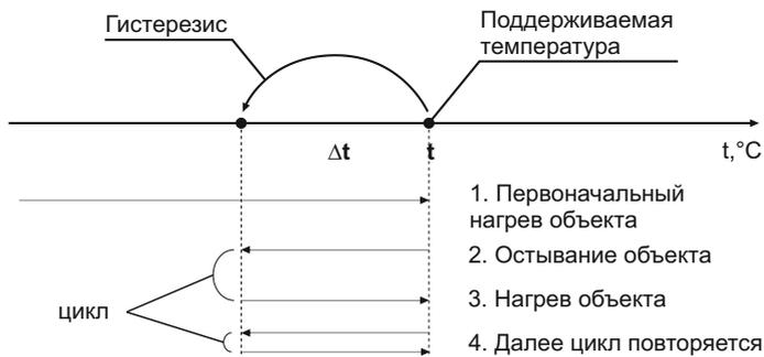
Гистерезис - это разница между температурой включения и отключения контактов реле терморегулятора (падение температуры).
