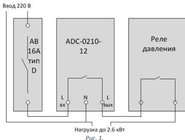
Подключение устройства должно производиться квалифицированным электриком. Устройство предназначено для установки внутри помещений. Необходимо исключить возможность попадания влаги или жидкости при эксплуатации. Конструктив устройства требует для крепления наличия DIN-рейки. Занимаемая ширина - 54 мм (три стандартных модуля).
